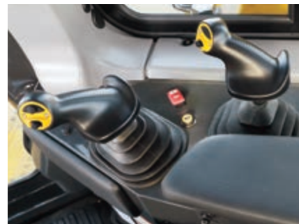
Palanca de control de la hoja con función de pitch automático y nueva palanca de control del ripper con función de retorno automático
