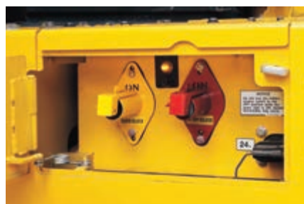
Desconector de batería automático con espacio para pinzas de arranque.
