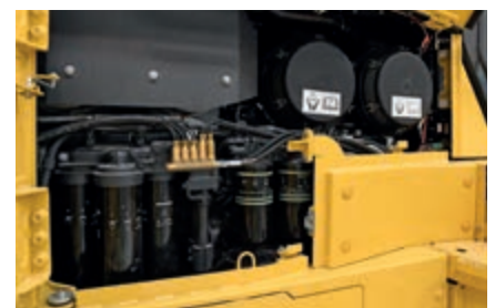
Komatsu ha creado el modelo D475A-8 con puntos de mantenimiento estratégicamente dispuestos para facilitar y acelerar las revisiones y trabajos de mantenimiento necesarios.
