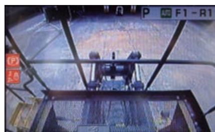
Sistema integrado de cámara para visibilidad trasera
