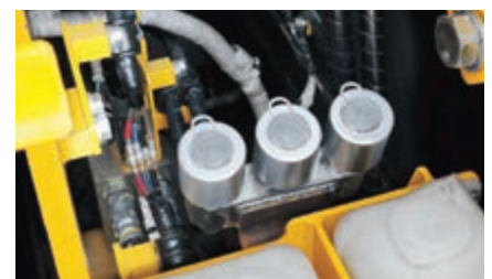
Los respiraderos con filtro externo facilitan las operaciones de control y de limpieza
