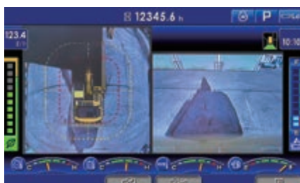
Gracias a KomVision y sus distintas opciones de cámara, se puede mantener una vista de pájaro constante desde encima de la máquina.
