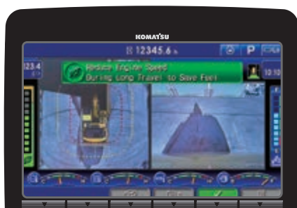
Eco-indicador, consejos de operación e indicador de consumo de combustible
