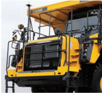
Acceso seguro a la cabina gracias al ángulo bajo de las escaleras delanteras, antideslizante y con barandilla.
