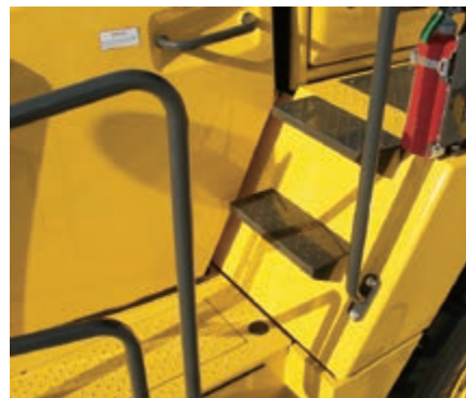
Acceso seguro a la cabina con barandillas, lejos de la peligrosa articulación
