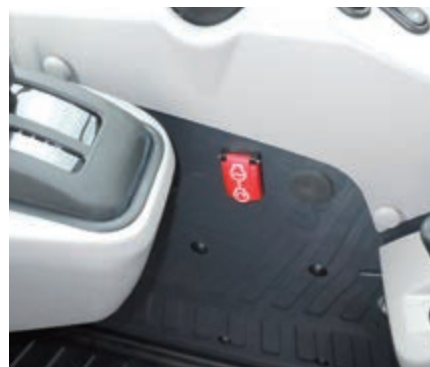
Interruptor de parada de emergencia del motor
