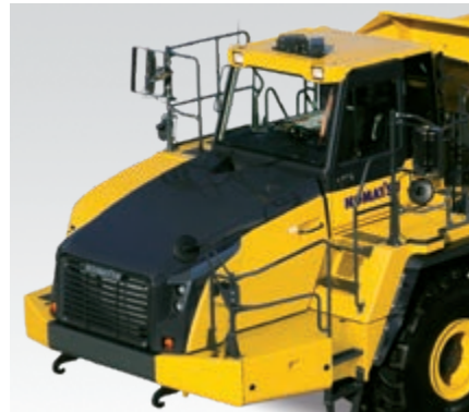
ROPS/FOPS integrado conforme con las normas ISO 3471 y SAE J1040-1988c
