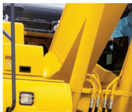
Placas superiores e inferiores de una única pieza, base de la pluma fundido
