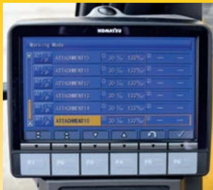
Komatsu Integrated Attachment Control (KIAC) para hasta 15 configuraciones de implementos para ajustar el caudal aceite y presión (opcional)
