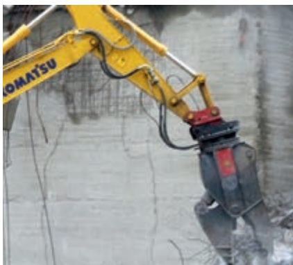
Dos líneas hidráulicas opcionales para montar una variedad de implementos
