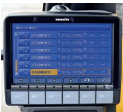
Komatsu Integrated Attachment Control (KIAC) para hasta 15 configuraciones de implementos para ajustar el caudal aceite y presión
