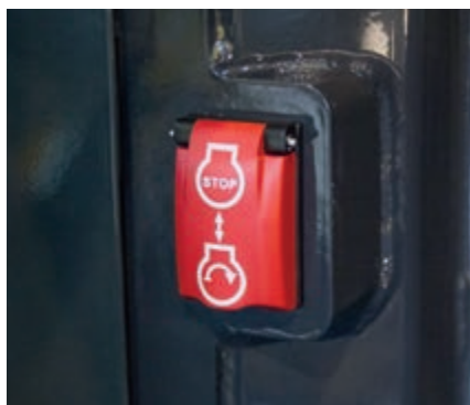
Interruptor de parada de emergencia del motor
