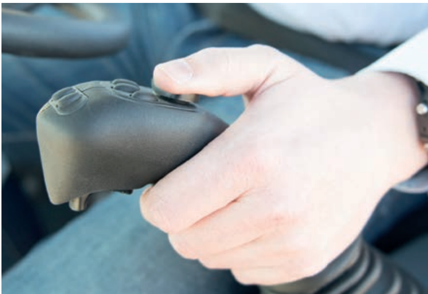
La opción de ajustar la palanca de dirección tipo joystick permite controlar la máquina con menos esfuerzo.
