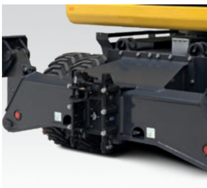
Distintos enganches para remolque disponibles
