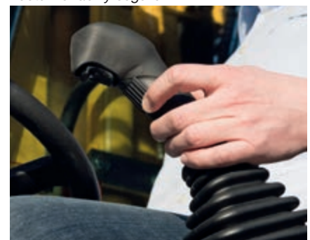
La opción de ajustar la palanca de dirección tipo joystick permite controlar la máquina con menos esfuerzo.
