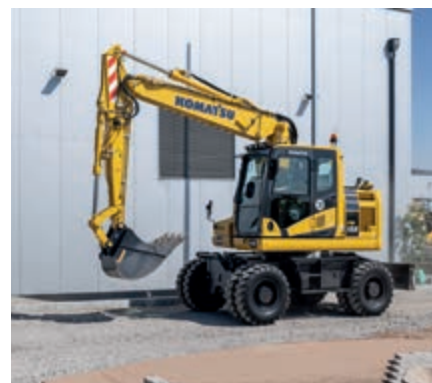
Sistema de suspensión de carga en la pluma (ECSS) para una mayor comodidad
