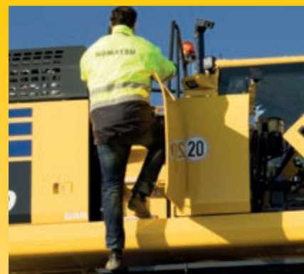
Escalera recta de acceso para servicio, barandillas y pegatinas antideslizantes
