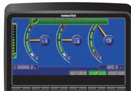
Ecoindicador, guía de eficacia, aviso de ralentí y apagado automático a ralentí ajustable ayudan a reducir el consumo de combustible
