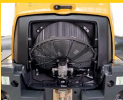
Ventilador abatible le permite un acceso fácil para la limpieza del radiador
