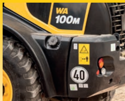
Línea de transmisión hidrostática limitada a 40 km/h (opcional)
