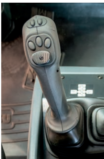
Joystick multifunción PPC con opcional actuación eléctrica proporcional de la 3ª y 4ª función (EPC)
