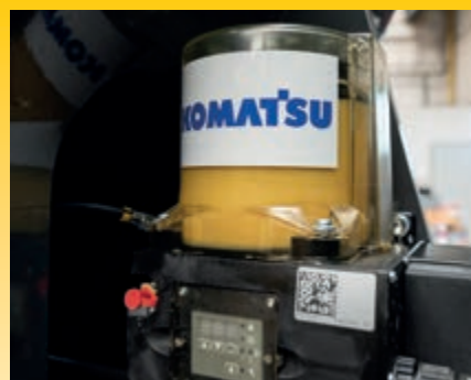
El sistema de engrase automático integrado de fábrica reduce los trabajos de servicio diario al mínimo (optional)
