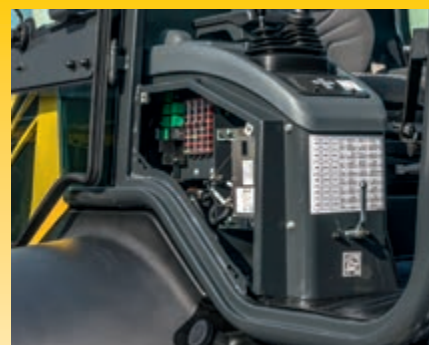
Cubierta lateral para un acceso rápido durante las tareas de mantenimiento
