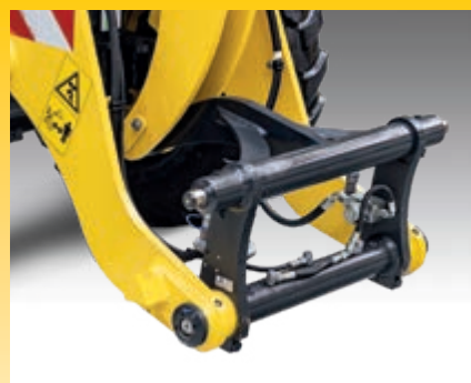
Enganche rápido accionado eléctricamente para un rápido y fácil cambio de implementos
