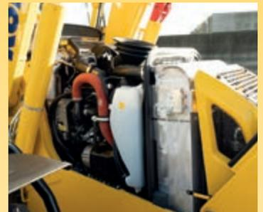
El mantenimiento diario mejora gracias a la apertura delantera de doble posición, y por la posición del punto de comprobación, de fácil acceso, a la izquierda
